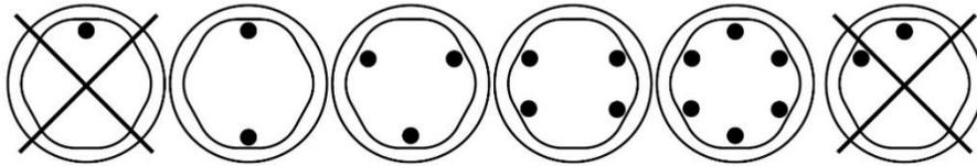
*Les godets peuvent être placés autour du rotor dans toutes les configurations de chargement illustrées. Les tubes doivent être chargés de façon symétrique dans chaque godet (comme dans l'illustration ci-dessus).*
