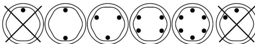
*Bøtter kan plasseres rundt rotoren i alle de viste rotorbelastningskonfigurasjonene.
