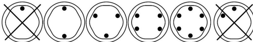
*Las cubetas pueden colocarse alrededor del rotor en cualquiera de las configuraciones de carga que se indican. Cada cubeta debe cargarse con tubos de forma simétrica, tal como se indica arriba.*
