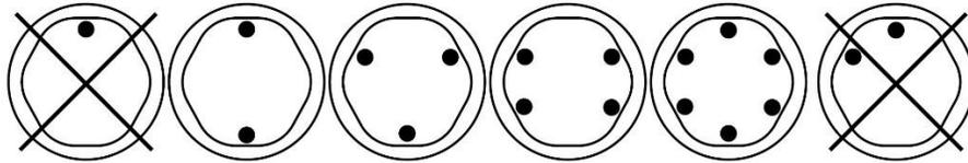
*Kovalar, gösterilen rotor yükleme konfigürasyonlarından herhangi birinde rotorun etrafına yerleştirilebilir. Her kova, yukarıdaki gibi tüplerle simetrik olarak yüklenmelidir.*
