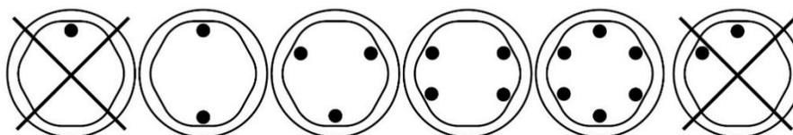
*Kubeczki można umieszczać wokół rotora w dowolnej z przedstawionych konfiguracji ładowania rotora. Każdy kubeczek musi być symetrycznie załadowany próbkami, jak opisano powyżej.*
