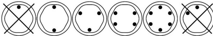
*Die Behälter können in jeder der dargestellten Beladekonfigurationen um den Rotor platziert werden. Jedes Behältnis muss mit den Röhrchen symmetrisch beladen werden, so wie oben dargestellt.*
