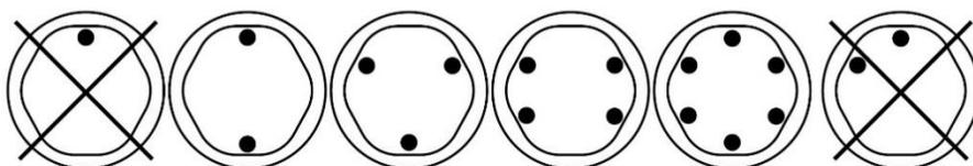
*Nádoby lze na obvod rotoru umísťovat v kterékoli ze znázorněných konfigurací zatížení rotoru. Každá nádoba musí být vložena symetricky k ostatním zkumavkám – viz výše.*
